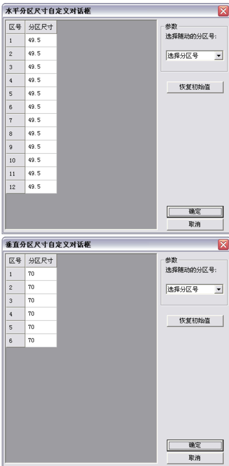
图 5-4 水平分区尺寸自定义对话框和垂直分区尺寸自定义对话框 全部图框参数设置完成后，单击【幅面设置对话框】的【确定】按钮即可生成图框。
