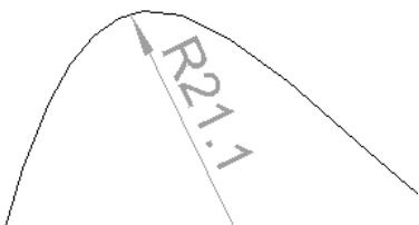
图 3-37 曲率半径标注示例
